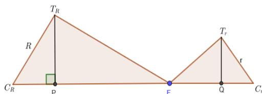
Onde  $T_R$  e  $T_r$  son os puntos de corte das tanxentes trazadas dende  $F$  ás esferas,  $R - H$  é a distancia de  $C_R$  a  $P$  e  $r - h$  a distancia de  $Q$  a  $C_r$ .  $C_R$  e  $C_r$  son os centros de ambas esferas.
